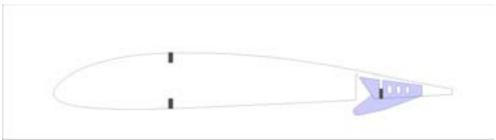
31. Cut the wing ends from the side of the ailerons. Ścinamy końcówki skrzydeł od strony lotek
